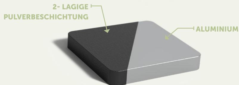
Nach der Herstellung des Aluminium-Pflanzgefäßes wird dieses einer Reihe von Nachbehandlungen unterzogen. Das Material wird aufgeraut, damit die Pulverbeschichtung besser haftet. Diese Pulverbeschichtung ist in verschiedenen Farben erhältlich und wird mit einer stark haftenden Grundierung aufgetragen. Zum Schluss wird das Pflanzgefäß mit einer harten Deckschicht versehen. Dadurch ist das Pflanzgefäß Aluminium kratzfest.
